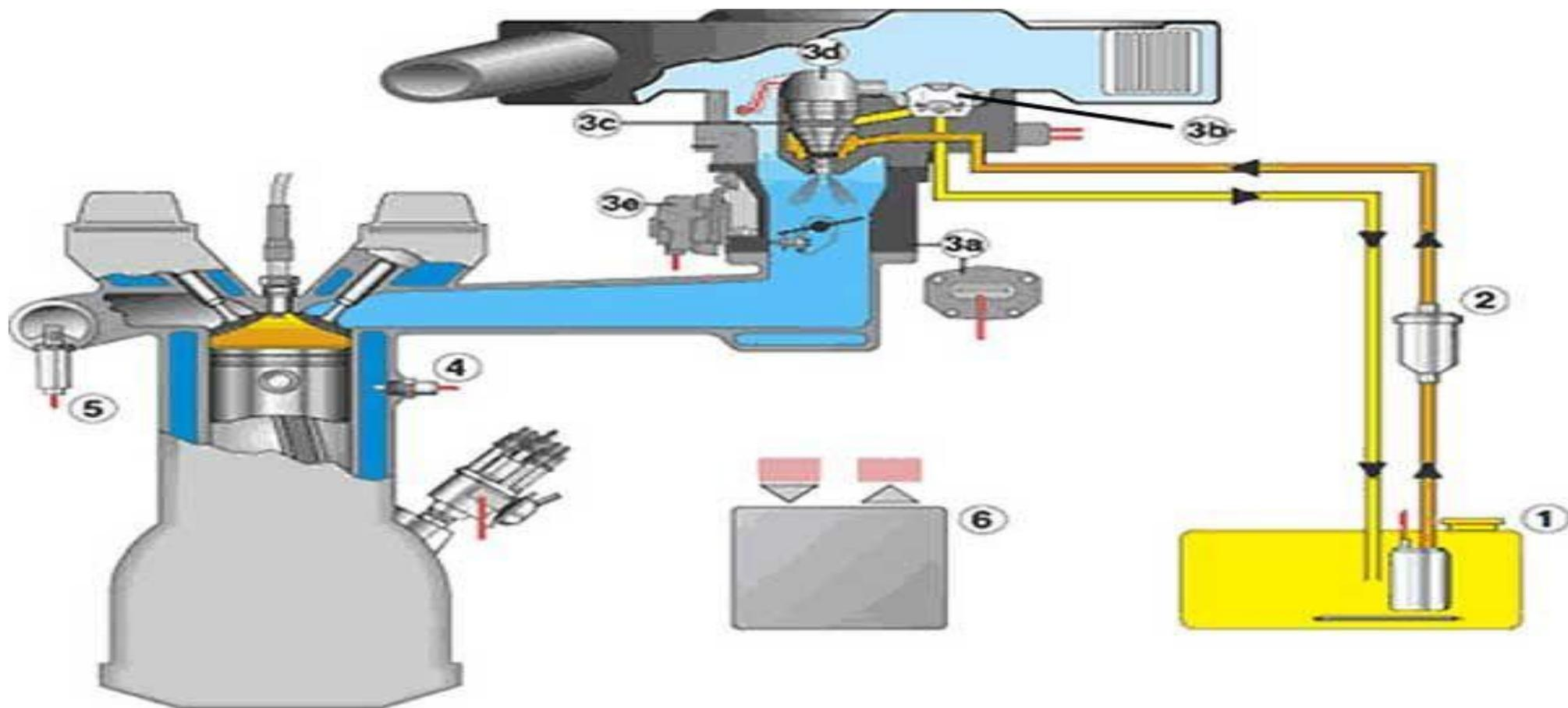
1. Электрический топливный насос
