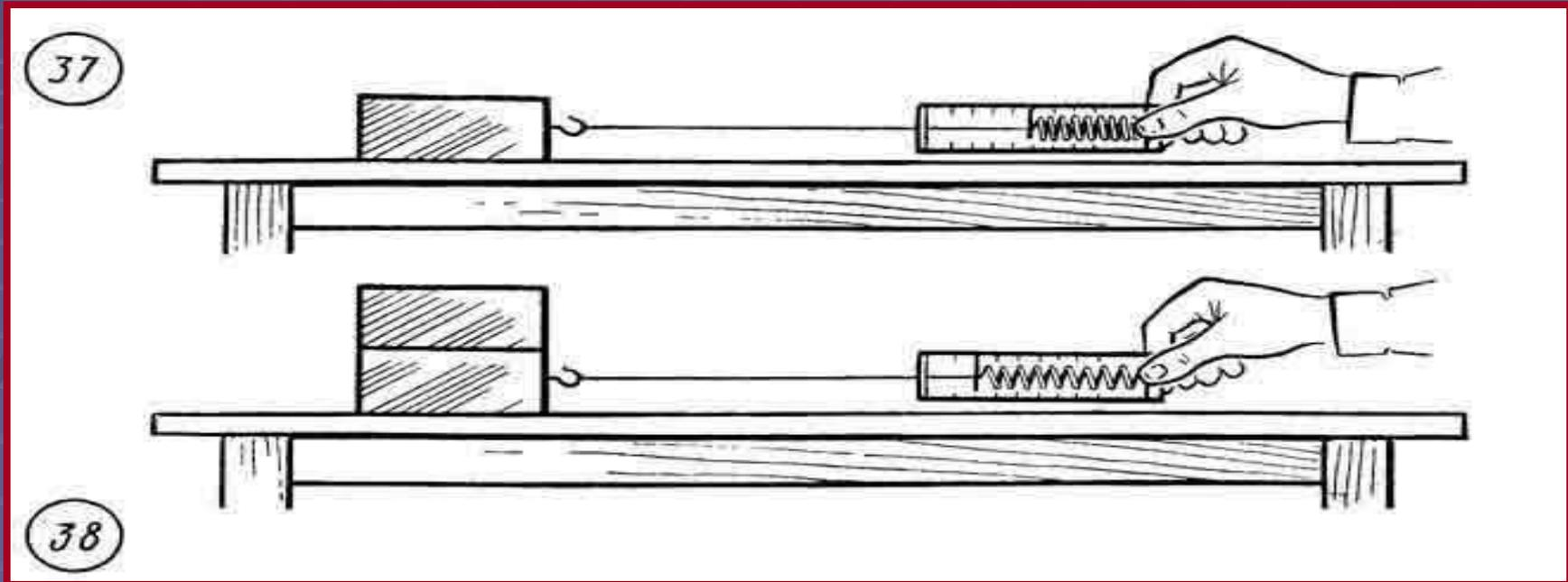
1. Динамометр держать строго параллельно поверхности, по которой скользит тело.
