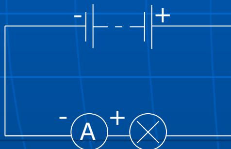
Силу тока измеряют амперметром.
