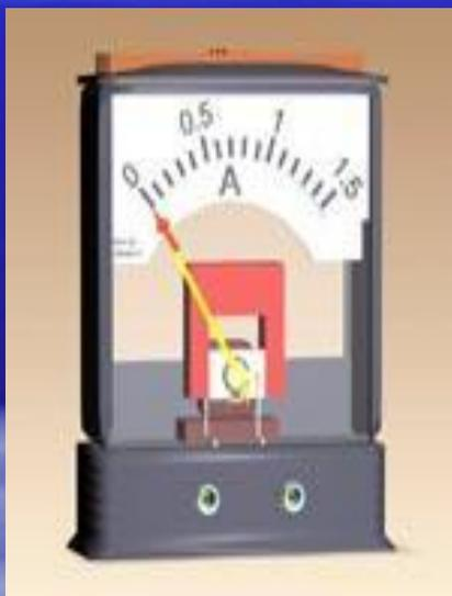
Прибор для измерения силы тока называется АМПЕРМЕТР. Амперметр включается в цепь последовательно.
