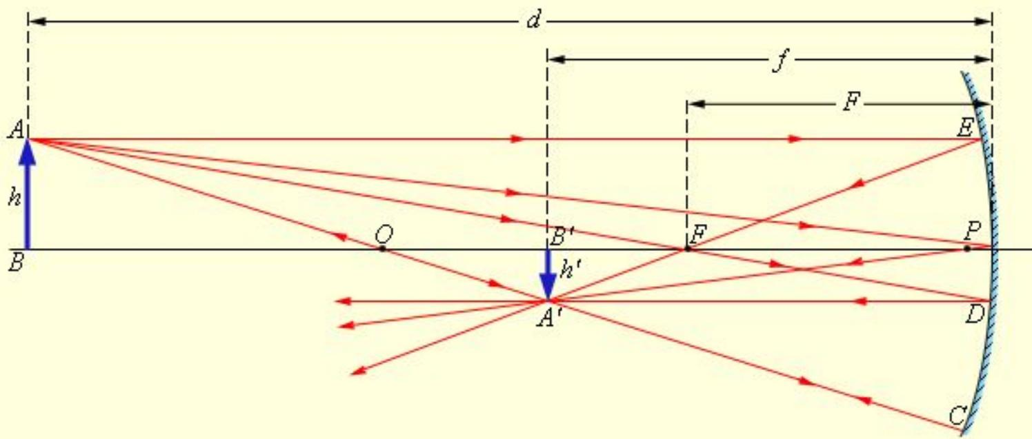
Луч АОС, проходящий через оптический центр зеркала;
