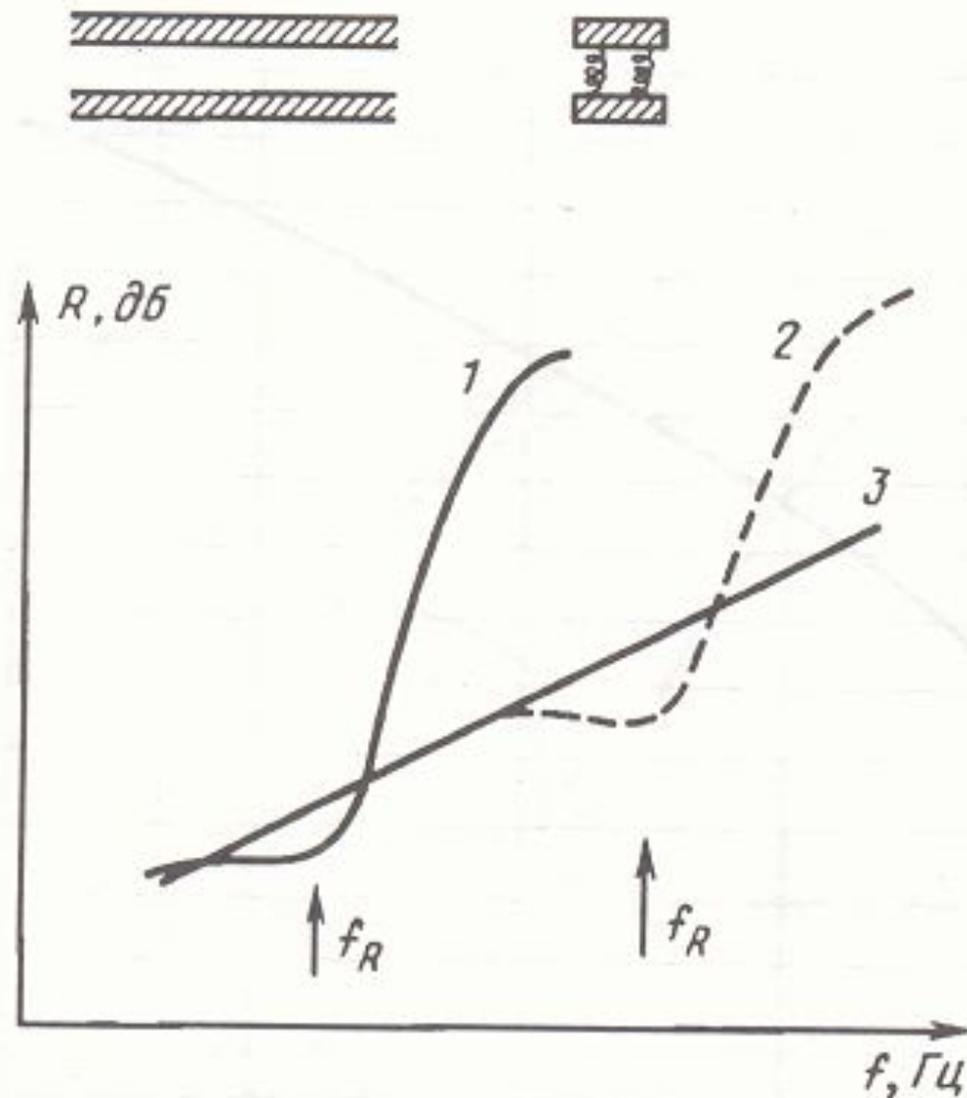
Рис. 8.30. Принципиальная схема работы двойной конструкции при большом
