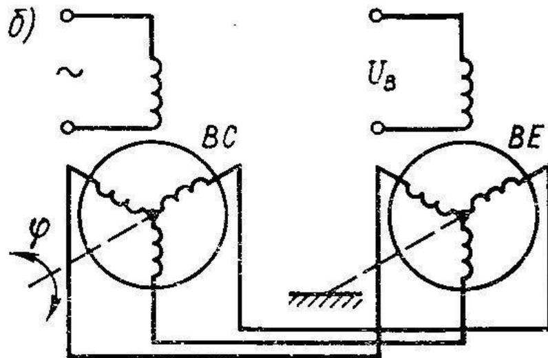
Схема синхронной передачи:
