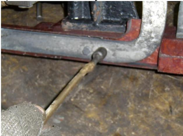
16. Токоподающую шину отсоединить, вывернуть шуруп, снять шайбу
