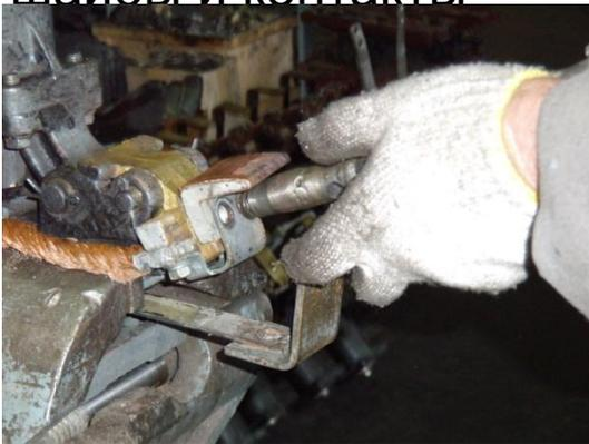
8. Отвернуть гайки болтов крепления шунта к угольнику, вывернуть болты, снять шайбы,
