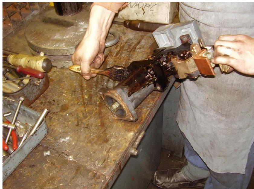
29. Полюса лакотканью заизолировать, планки и изоляцию на полюс наложить, заклепки расклепать
