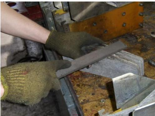
25. Пружины на упругость и прочность проверить, длину замерить, окрасить
