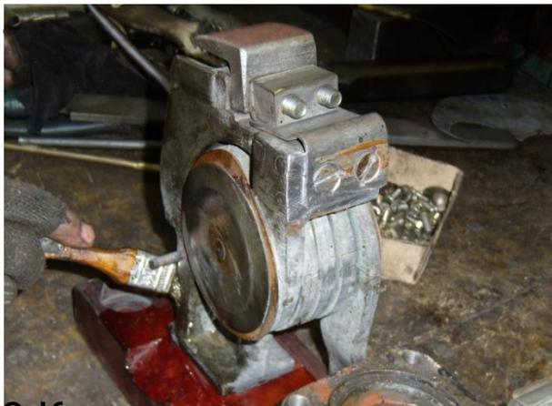
19.Контакты силовые под наплавку зачистить, заготовки порезать, проволокой на контактах закрепить, контакты по ширине и длине опилить
