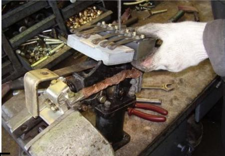
6. Болты крепления пружин дугогасительной камеры вывернуть, шайбы снять
