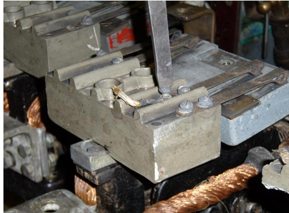
5. Затем вывернуть шурупы и крепление основания пальца с изоляцией и шурупы крепления блокировочных контактов. Снять колодку
