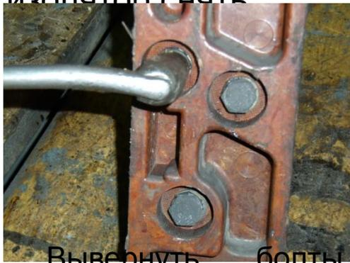
15. Вывернуть болты крепления кронштейна неподвижного контакта к изоляционной панели контактора, снять шайбы и кронштейн с катушкой
