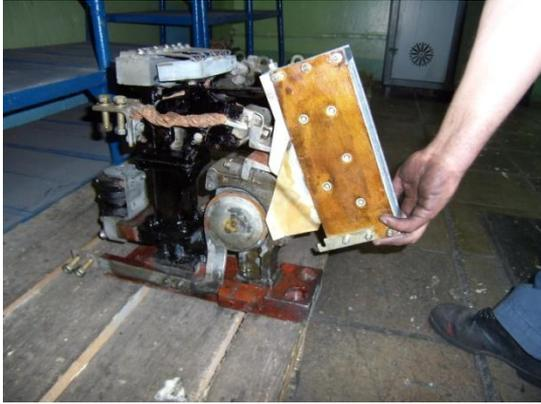
2. отвернуть гайки крепления полюсов, снять шайбы, вынуть болты, снять полюса и перегородку гаечным ключом
