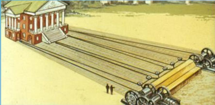
Простые механизмы помогут передвинуть дом, чтобы расширить улицу. Под дом подводят рамы, опускают на катки, уложенные на рельсы, и включают электролебедки.
