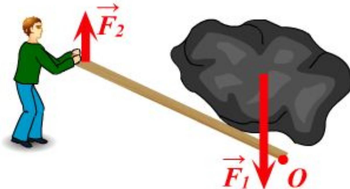
У рычагов второго рода неподвижная точка опоры располагается по одну сторону линий действия приложенных сил. Для того чтобы приподнять тяжелый предмет надо приложить силу, направленную вверх.
