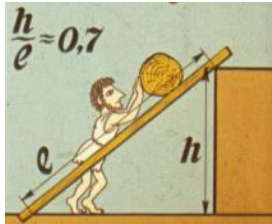
**Винт** — простой механизм. Резьба винта, в сущности, представляет собой другой простейший механизм — наклонную плоскость, многократно обёрнутую вокруг цилиндра.
