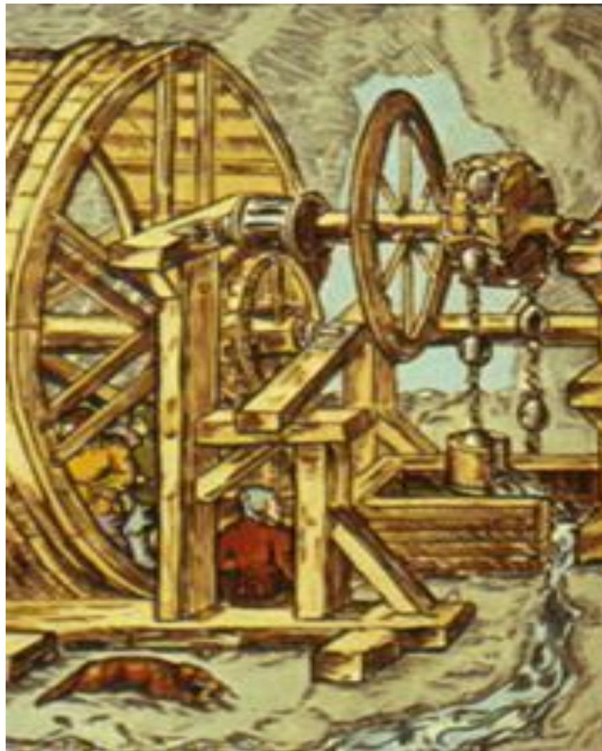
**Лебедка** - конструкция , состоящая из двух воротов с промежуточными передачами в механизме привода.
