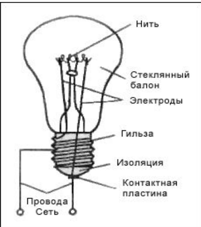
Принцип действия ламп накаливания это преобразование электрической энергии в световую энергию. Вольфрамовая нить разогревается до температуры  $2600 - 3000 \text{ C}$ , но нить не плавится так как температура плавления вольфрама равна  $3200 - 3400 \text{ C}$ . И это явление позволяет нам использовать вольфрам в качестве нити накаливания.
