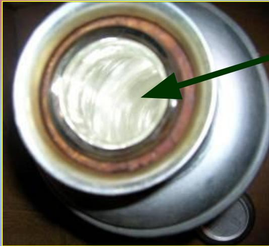
Внутренняя стеклянная колба термоса имеет двойные стенки, между которыми вакуум. Это позволяет предотвратить потерю тепла в результате теплопроводности.
