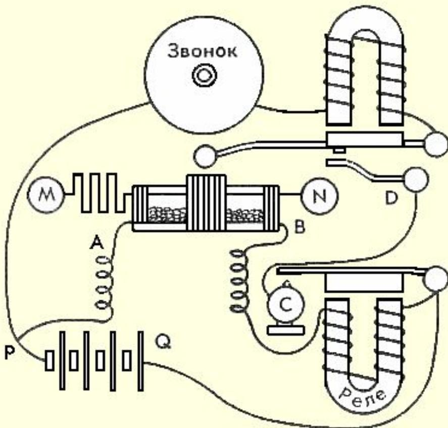
В своем радиоприемнике в качестве детали, непосредственно чувствующей электромагнитные волны, А.С. Попов применил **когерер**. Что бы повысить чувствительность аппарата, один из выводов когерера заземлил, а другой присоединил к высоко поднятому куску проволоки, создав **первую приемную антенну**.
