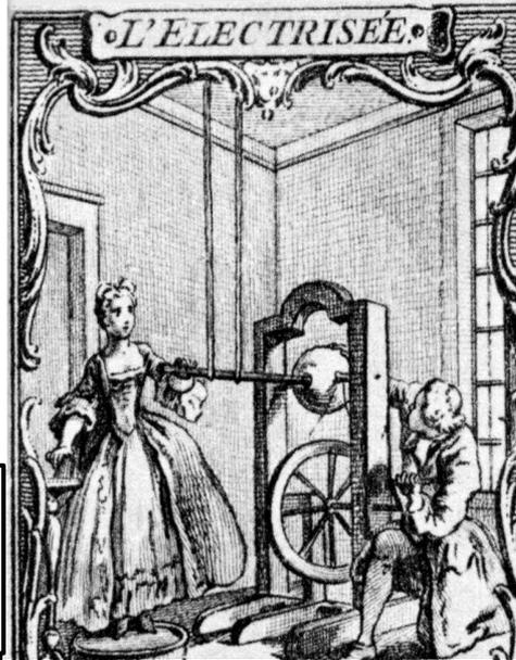
Гравюра 1750 года, демонстрирующая устройство для получения статического электричества.
