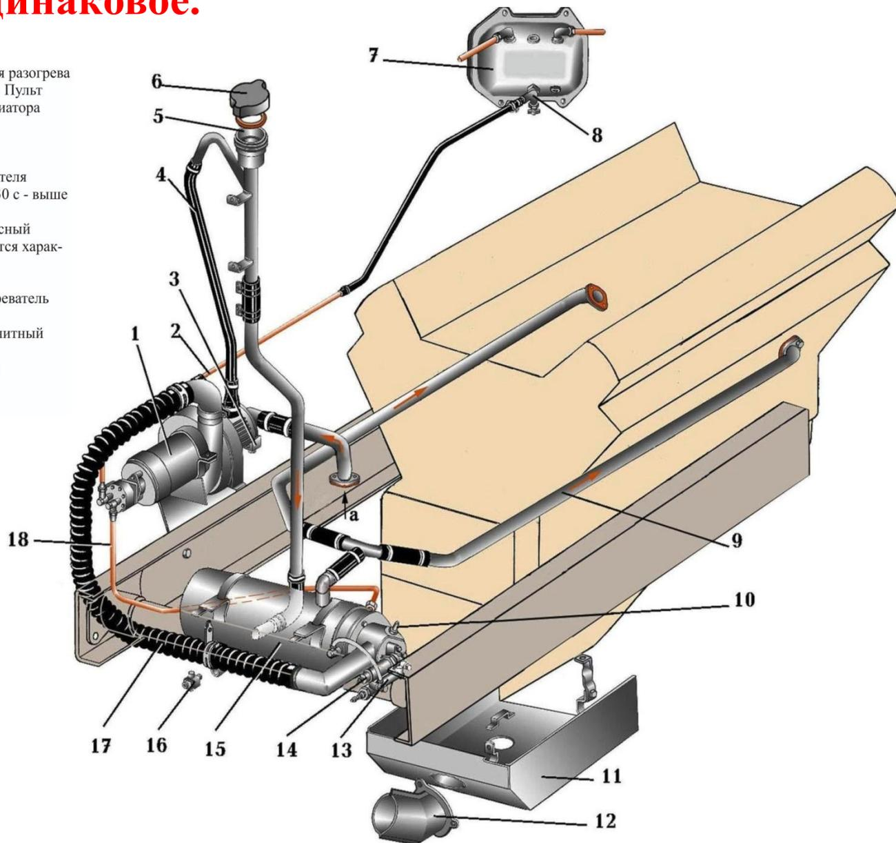
**Горелка** съёмная, крепится к котлу 4-мя болтами. **Назначение:** в горелке топливо смешивается с воздухом. На горелке установлена электроискровая свеча, электромагнитный топливный клапан с форсункой и электронагревателем топлива.
