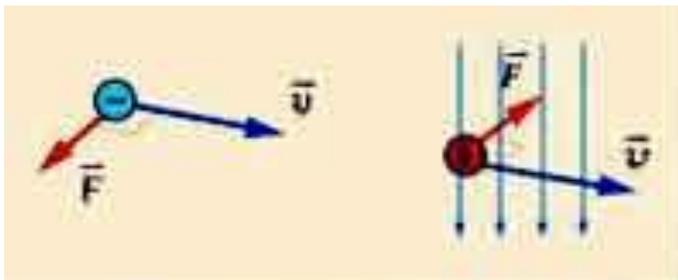
Если **ЛЕВУЮ РУКУ** расположить так, чтобы линии магнитного поля входили в ладонь перпендикулярно к ней, а четыре пальца были направлены по движению положительно заряженной частицы (или против движения отрицательно заряженной частицы), то отставленный на 90 градусов большой палец покажет направление действующей на частицу силы.
