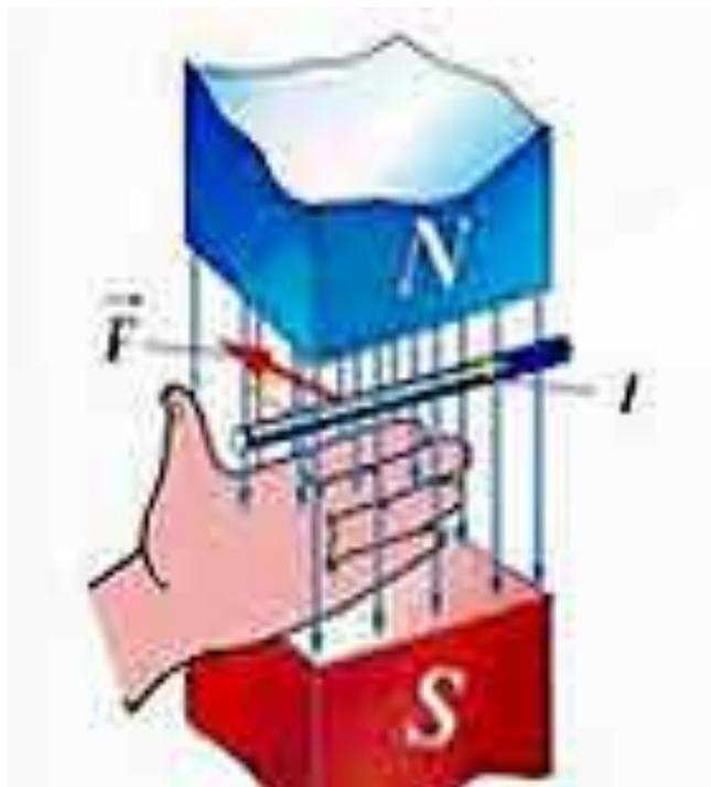
Если **ЛЕВУЮ РУКУ** расположить так, чтобы линии магнитного поля входили в ладонь перпендикулярно к ней, а четыре пальца были направлены по току, то отставленный на 90 градусов большой палец покажет направление действующей на проводник силы.
