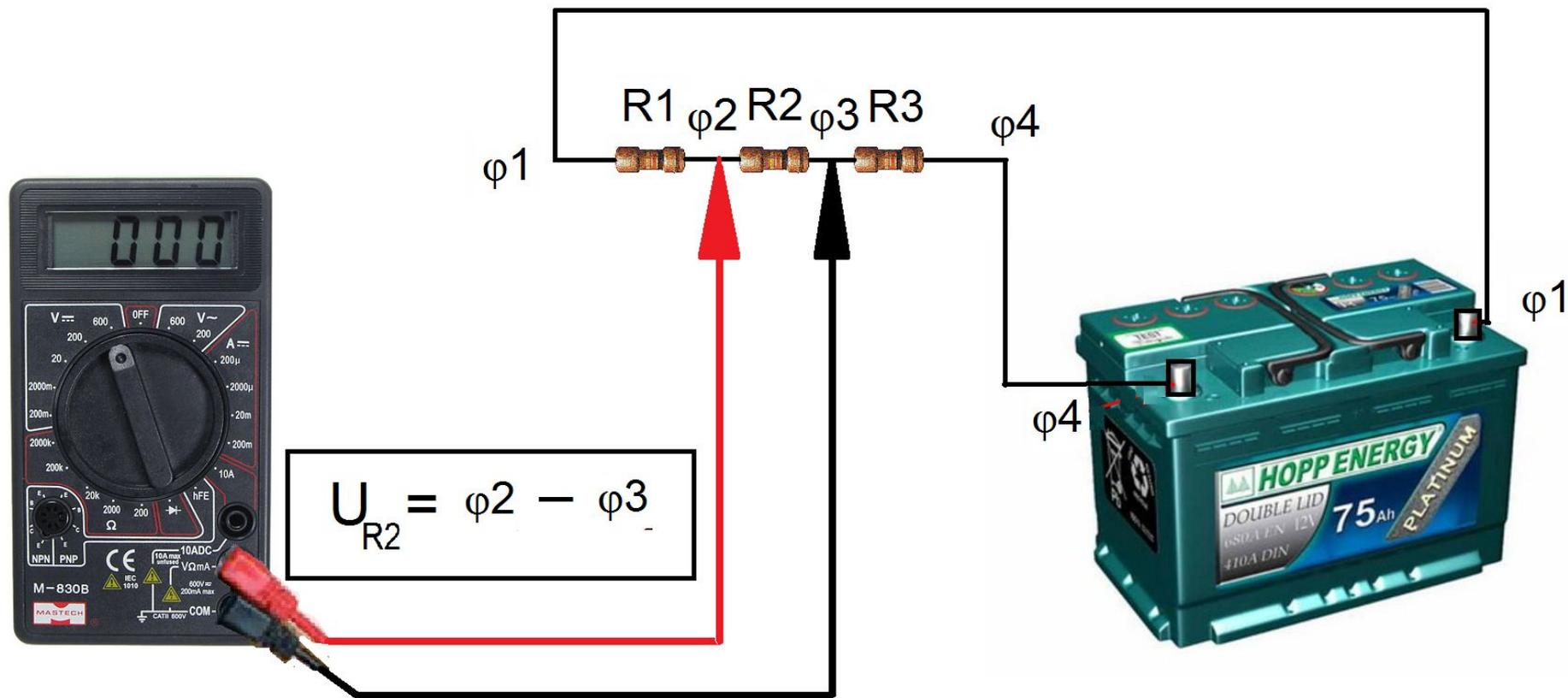
Рис.9.2. Измерение напряжения
