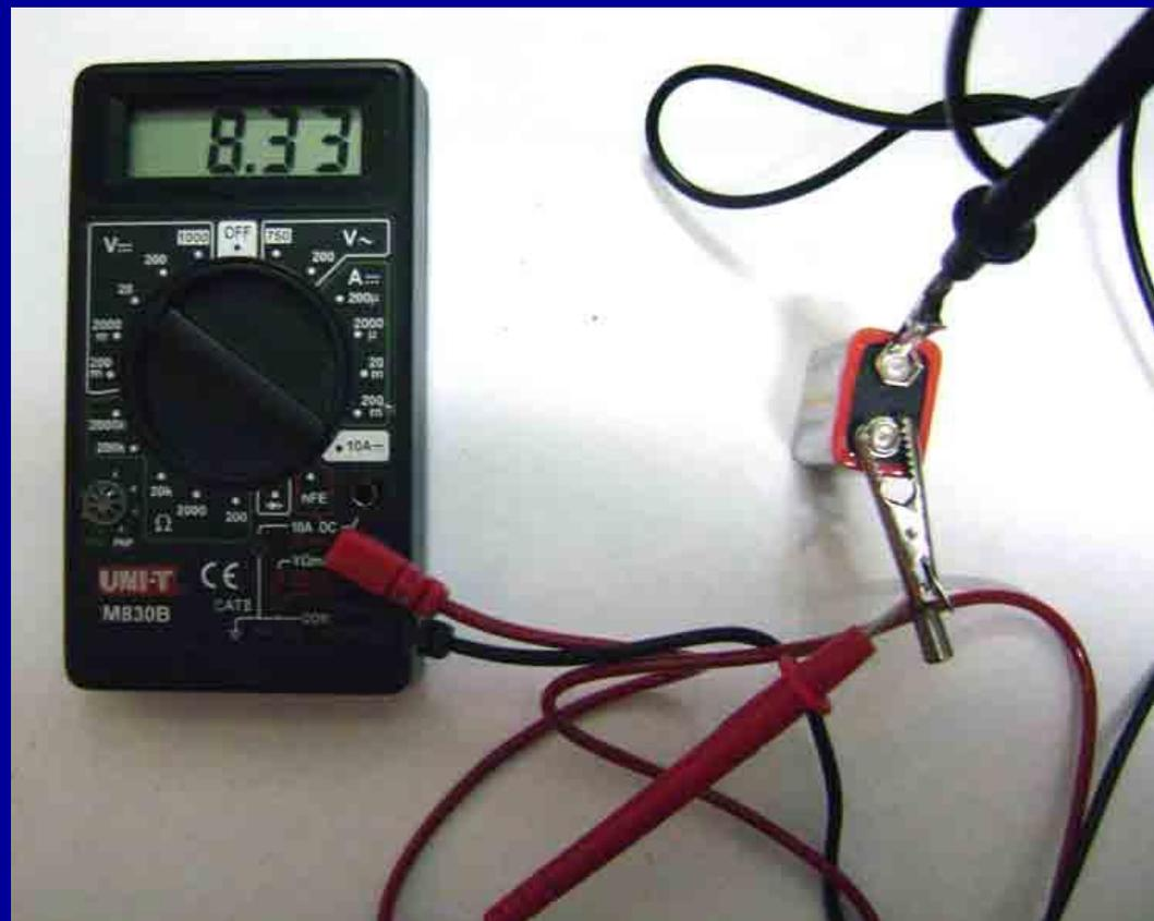
Рис. 9.1. Замер ЭДС источника
