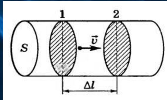
Если средняя скорость упорядоченного движения свободных зарядов  $v$ , то за промежуток времени  $\Delta t = \frac{\Delta l}{v}$  все частицы, заключенные в рассматриваемом объеме, пройдут через сечение 2. Поэтому сила тока:
