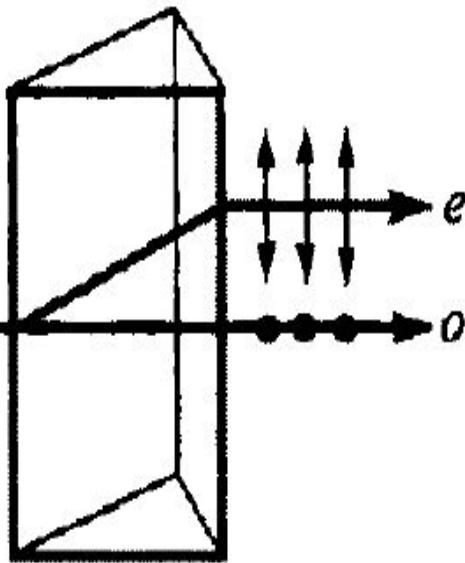
Если на кристалл направить узкий пучок света, то из кристалла выйдут два пространственно разделенных луча параллельных друг друга и падающему лучу. один из них является продолжением первичного (называется **обыкновенным (о)**), а второй отклоняется (называется **необыкновенным (е)**).
