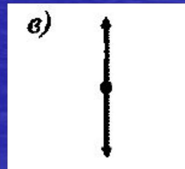
Плоскость в которой колебается световой вектор **E** в плоскополяризованной волне, называется **плоскостью колебаний**.
