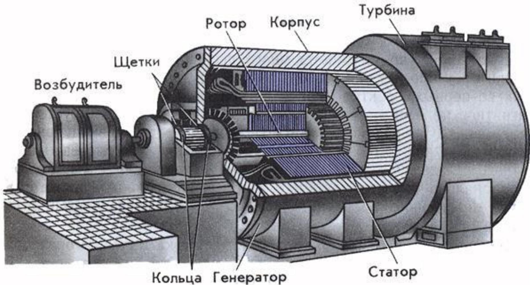
1- статор, 2 – ротор, 3 – водяная турбина.
