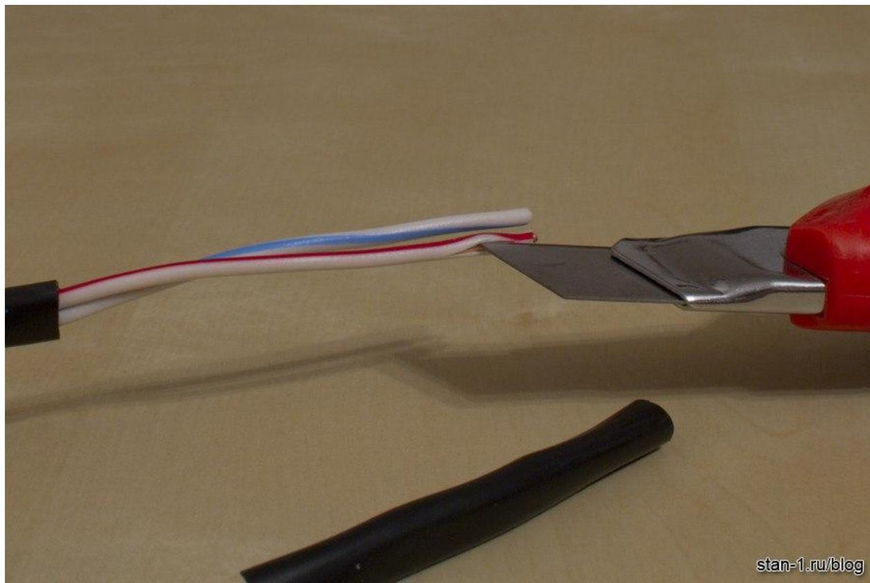
После снятия изоляции, оголенные концы проводов зачищают, а многопроволочные жилы скручивают. Последнюю операцию выполняют вручную плоскогубцами или с помощью специальных приспособлений. Подготовленные концы проводов подвергают горячему облуживанию путем погружения в ванну с припоем.
