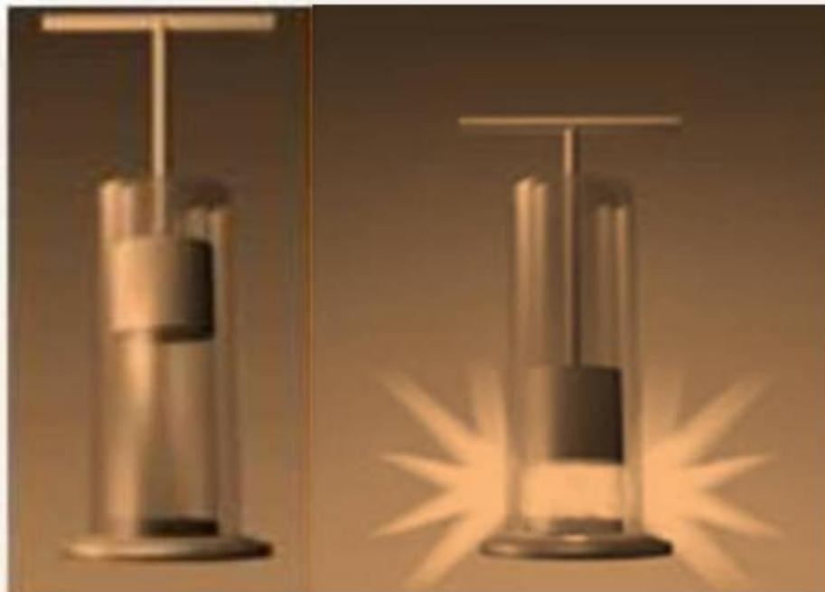
На явлении разогрева газа при его адиабатическом сжатии основано явление пневматического огнива, которое находит применение в дизелях, где воспламенение горючей смеси осуществляется путём адиабатического сжатия.
