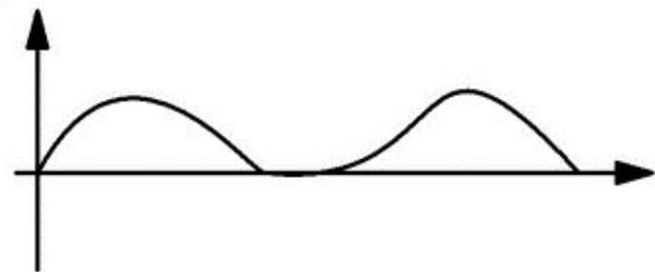
Диод пропустил через себя только положительную полуволну переменного сигнала
