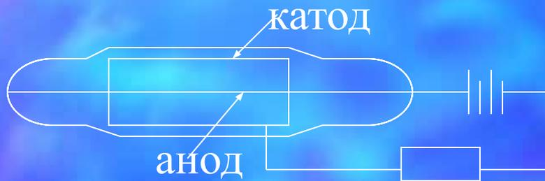
Счетчик состоит из закрытой трубки, по оси которой натянута, струна (А), а стенки покрыты тонким проводящим слоем (К). Трубка заполнена аргоном.
