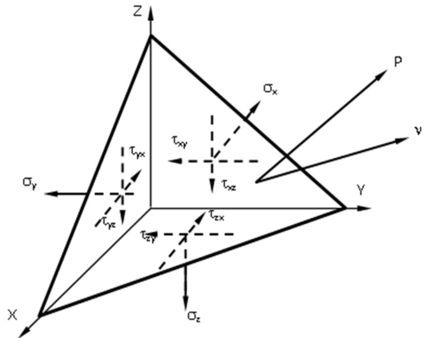
Положение наклонной площадки характеризуется вектором нормали  $v$  с направляющими косинусами  $l, m, n$ . На наклонной площадке площадью  $dF$  действует полное напряжение  $P$  с проекциями по осям  $P_x, P_y, P_z$ . Пусть нормальные и касательные напряжения на гранях, совпадающих с координатными плоскостями, известны. Необходимо найти нормальное и касательное напряжение на наклонной площадке -  $\sigma_v$  и  $\tau_v$ . Площадки, отсекаемые на координатных плоскостях, будут иметь площади:
