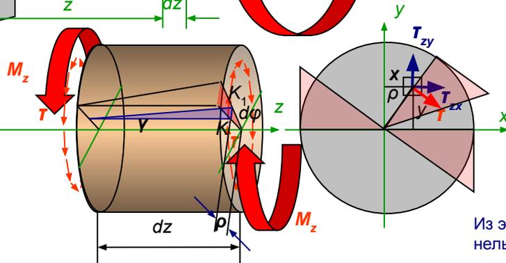
Полученная формула показывает, что касательные напряжения линейно зависят от расстояния рассматриваемого волокна до центральной оси и принимают максимальные значения при  $\rho = \rho_{\max}$ :
