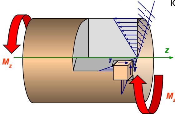
Каждый прямоугольный элемент материала испытывает **напряженное состояние чистого сдвига**.
