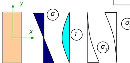
Поскольку эпюры касательных напряжений имеют скачки в местах резкого изменения ширины поперечного сечения (двутавр, швеллер), то это найдет свое отражение на эпюрах главных напряжений.
