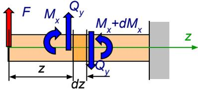
Выделим малый элемент двумя нормальными к оси бруса и заменим действие отброшенных частей нормальными напряжениями и касательными напряжениями. Под их действием элемент находится в равновесии.
