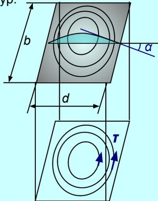
Поперечная нагрузка, например, давление воздуха (дутье), вызывает прогибы поверхности. Сечения поверхности горизонтальными плоскостями дают линии равных прогибов (горизонтали), расстояния между которыми обратно пропорциональны тангенсу угла наклона касательной и, значит, величине касательных напряжений. Направление вектора касательных напряжений совпадает с касательными к горизонталям.
