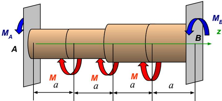
1. **Статика** – Отбрасываем жесткие заделки, заменяем их реактивными моментами:
