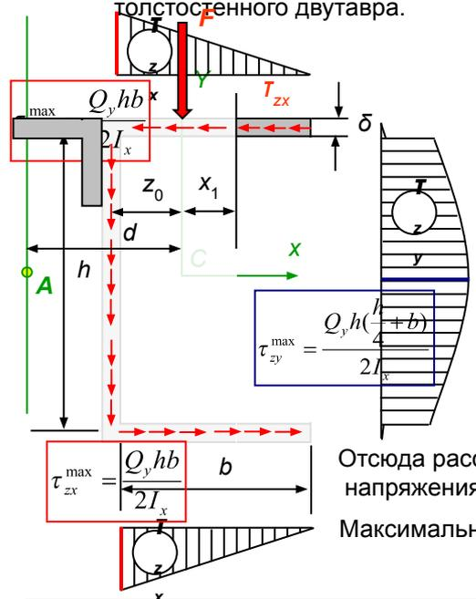
В полках возникают горизонтальные касательные напряжения  $\tau_{zx}$ , которые могут быть определены по формуле Журавского, при этом статический момент площади, отсекаемой вертикальной плоскостью на расстоянии  $x_1$ , вычисляется по-прежнему относительно оси  $x$ :
