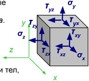
Представляет интерес исследовать, как *изменяются эти напряжения от изменения ориентации элемента*. Это позволит найти наклонные площадки, по которым напряжения принимают максимальные и нулевые значения. Рассмотрим эту проблему вначале для более простого случая – *плоского напряженного состояния*.
