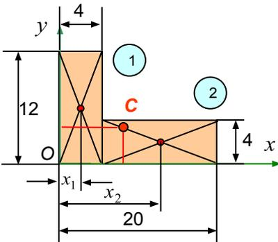
1. Выбираем систему координат  $x, y$  с началом в нижнем левом углу сечения.
