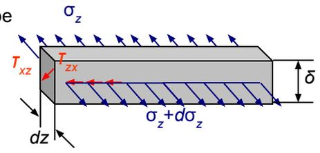
В отличие от предыдущего (определение вертикальных касательных напряжений) теперь статический момент отсеченной части изменяется по **линейному** закону:
