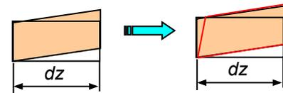
При вычислении касательных напряжений в угловых точках по формуле, выведенной при использовании гипотезы плоских сечений (круглые сечения), в углах прямоугольного сечения должны получаться максимальные касательные напряжения ( $\rho = \rho_{\max}$ ), а на самом деле в этих точках прямой угол остается прямым и касательные напряжения равны нулю.
