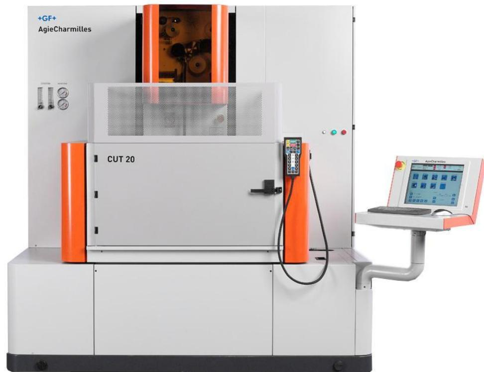
Рисунок 22.5- Электроэрозионный проволочно-вырезной станок AGIE CHARMILLES CUT 20
