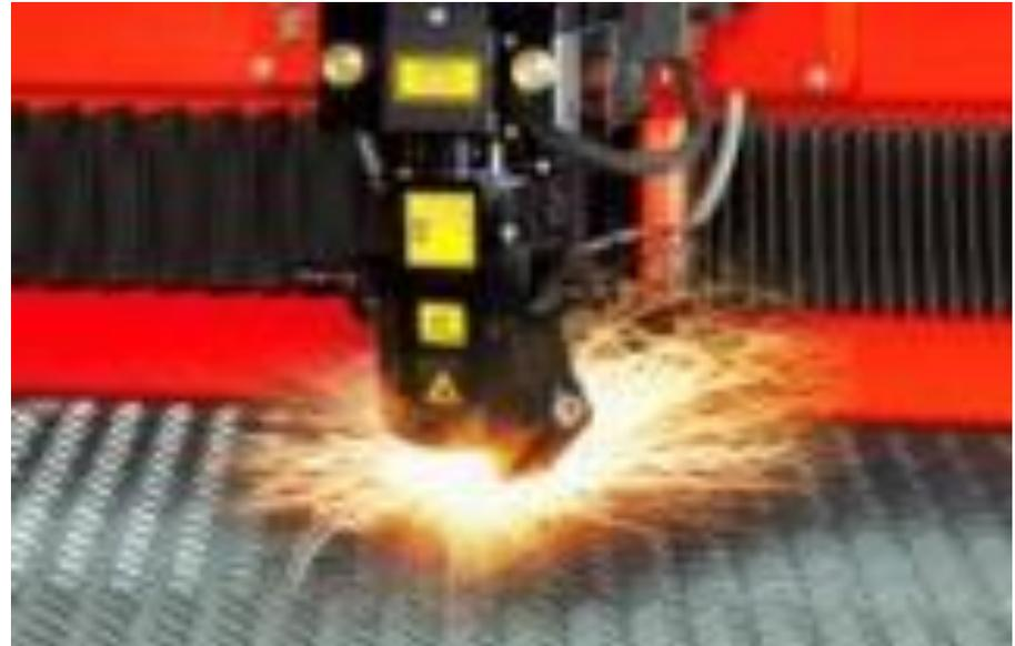
Рисунок 22.1-Процесс электрофизической обработки
