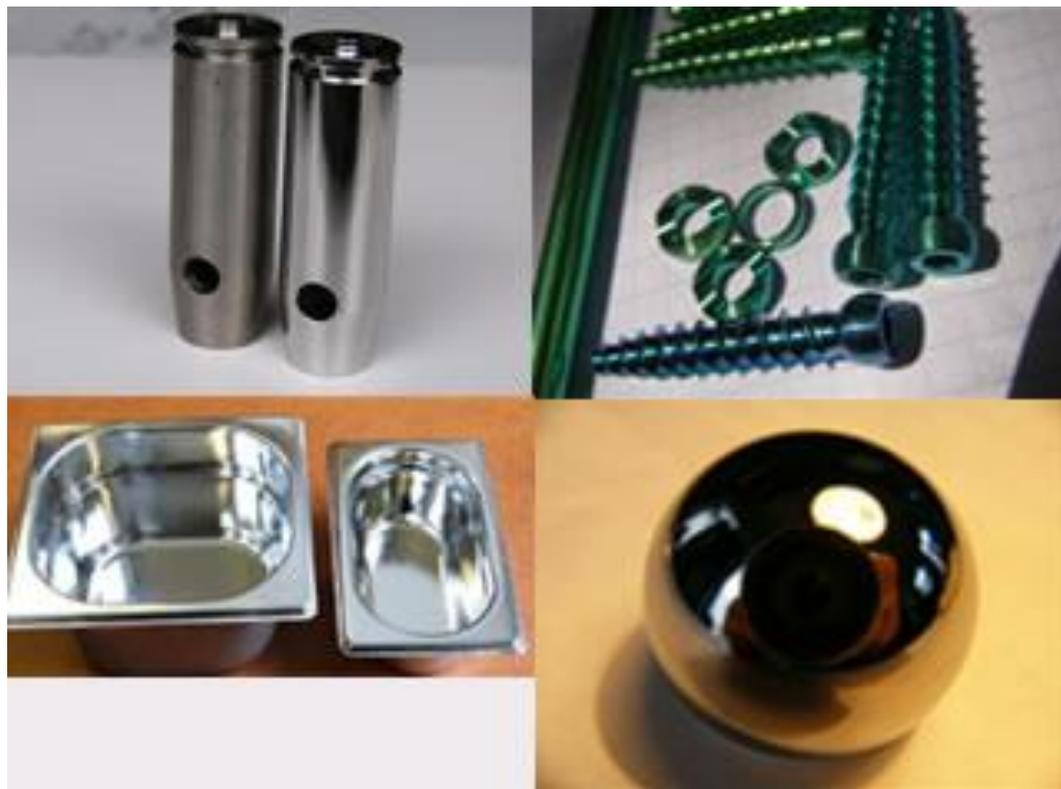
Рисунок 22.13-Химическое полирование
