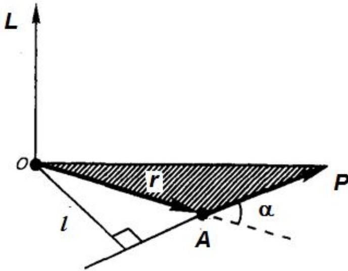
**Моментом импульса** материальной точки **A** относительно неподвижной оси **O** называется физическая величина, определяемая векторным произведением:
