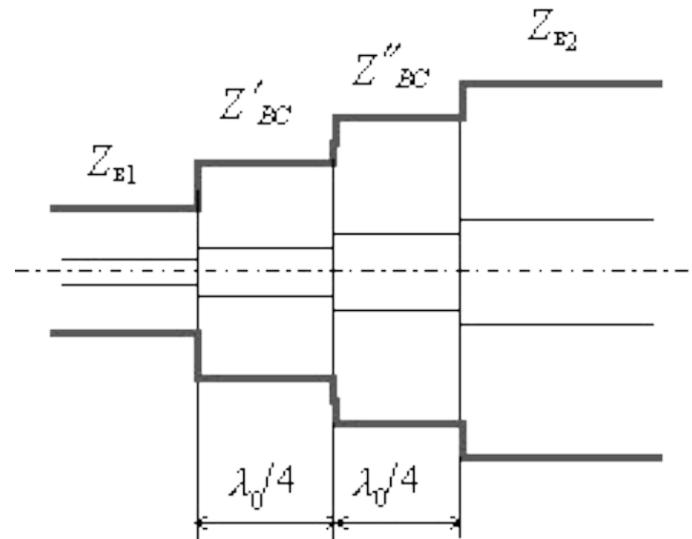
Ступенчатые переходы прямоугольного волновода (а) и коаксиальной линии (б)
