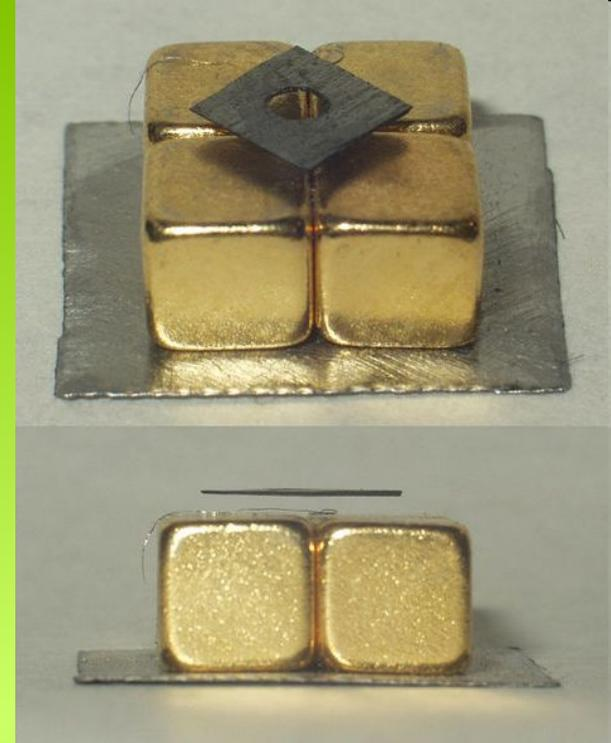
Диамagnetик в магнитном поле намагничивается таким образом, что на том его конце, где входят линии внешнего поля, образуется северный полюс, а с противоположной стороны — южный
