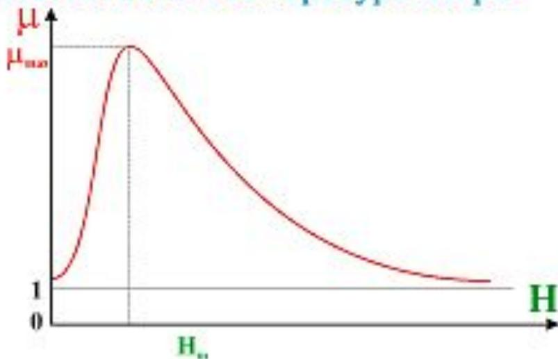
Зависимости магнитной проницаемости  $\mu$  ферромагнетика от напряженности магнитного поля  $H$
