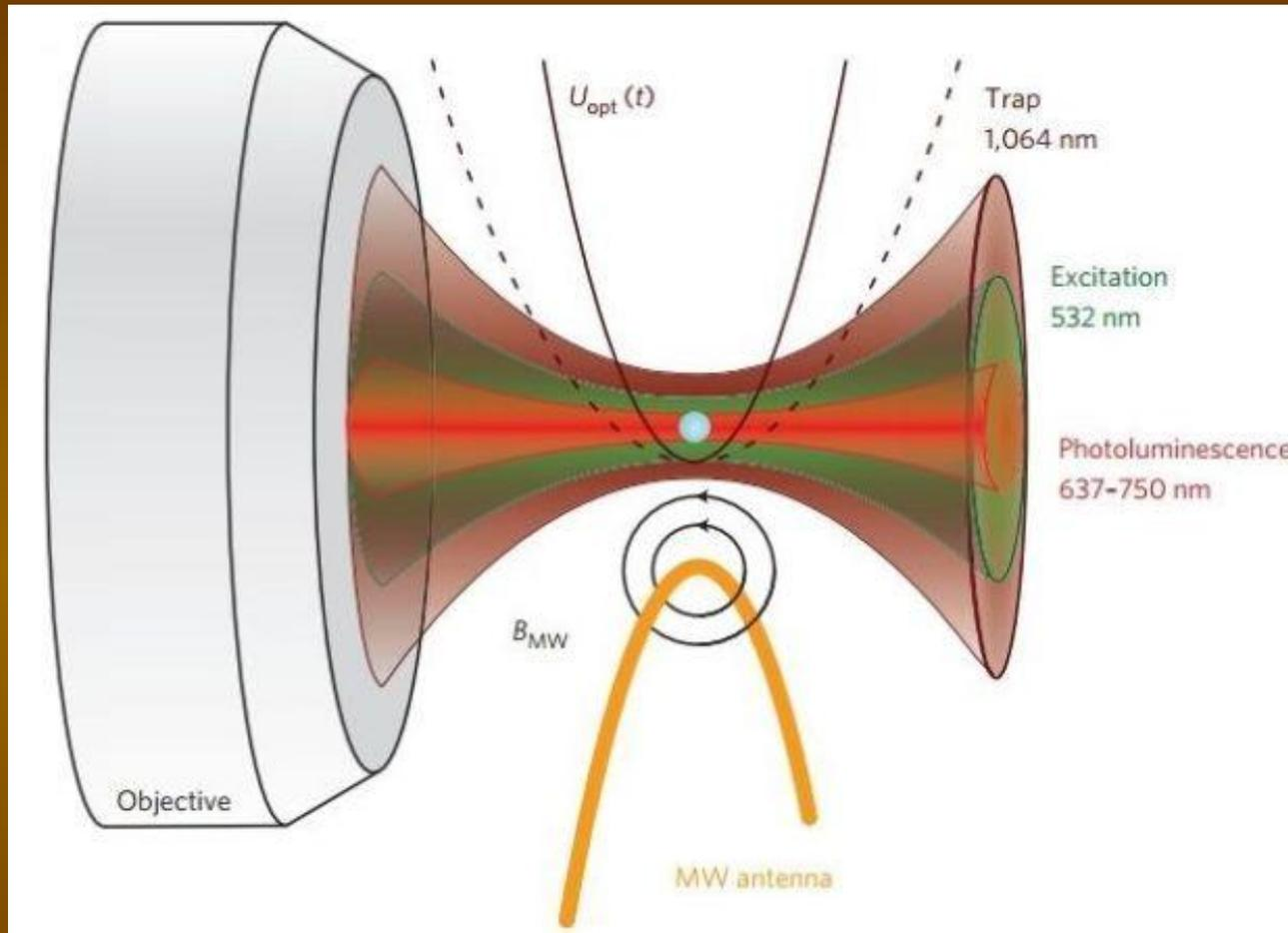
Лазерное излучение создает энергетическую яму в электромагнитном поле излучения, в которой колеблется наноалмаз.
