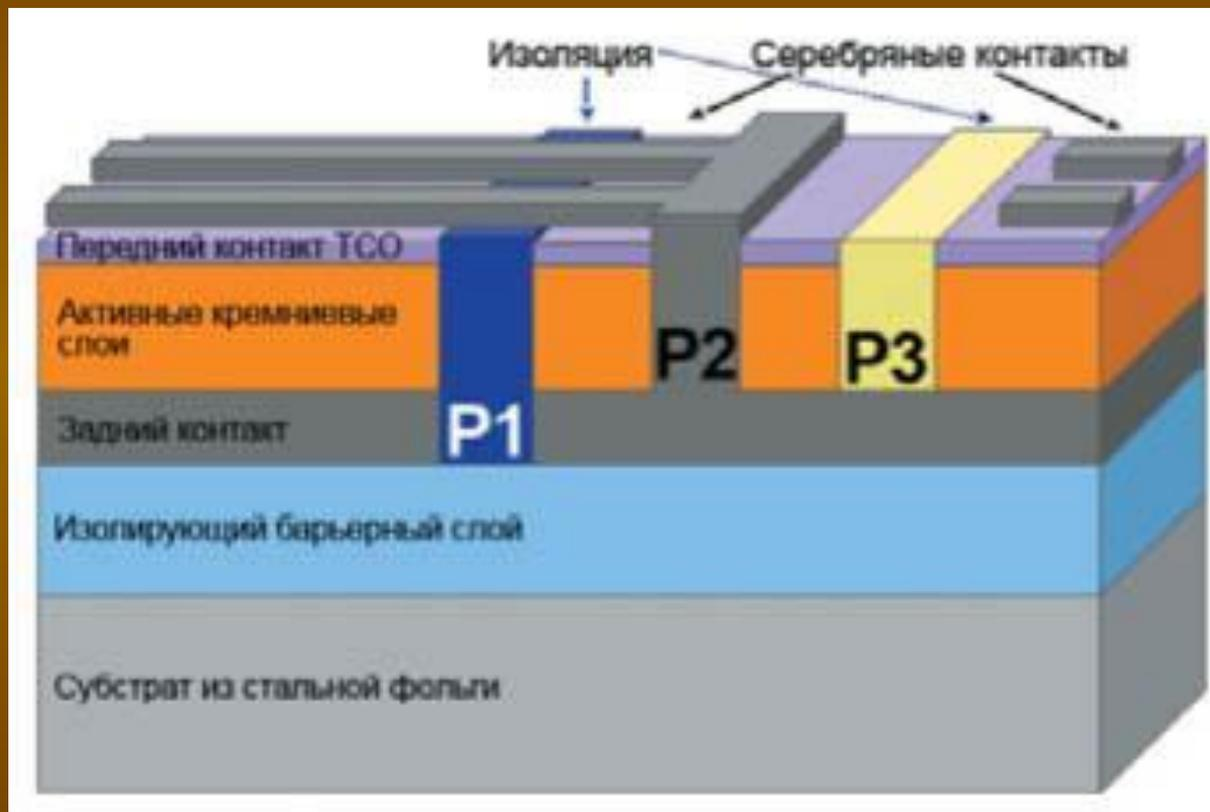
Устройство фотоэлемента на основе стальной фольги.
