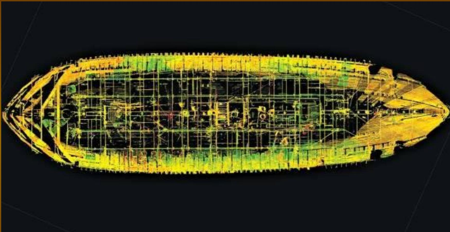
Полученное с помощью лазеров трехмерное изображение нижнего трюма. Судно имеет длину 34,7 м и ширину 8,5 м
