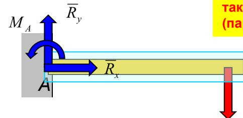
В жесткой плоской заделке возникает три реактивных усилия: две составляющие реактивные силы  $R_x$  и  $R_y$ , а также реактивный момент (пара сил)  $M_A$ .
