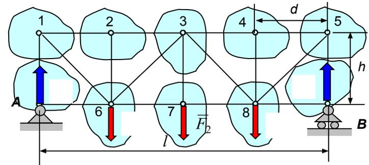
**Методы расчета.** Для расчета усилий, возникающих в стержнях ферм, используются метод вырезания узлов и метод сквозных сечений (метод Риттера).
