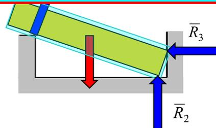
Реакция гладкой поверхности направлена перпендикулярно общей касательной плоскости, проведенной к соприкасающимся поверхностям тела и связи.
