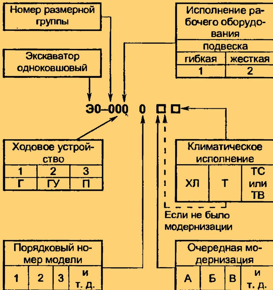
Для экскаваторов, стреловых и башенных кранов принята комбинированная индексация, включающая следующие характеристики: 1-я цифра — размерная группа. 2-я — тип ходового устройства, 3-я — исполнение рабочего оборудования, 4-я — порядковый номер модели. Буквы в индексе, которые стоят после цифр, обозначают очередную модернизацию (Л, Б, В, Г..); климатическое исполнение (УХЛ — холодного климата, Т — тропическое, ТВ — тропическое влажное; машины для умеренного климата не имеют такого обозначения).
