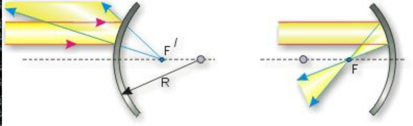
Направим пучок параллельных лучей на выпуклое зеркало (левый рисунок). После отражения лучи станут расходящимися. Поэтому выпуклое зеркало иначе называют *рассеивающим зеркалом*. Направим теперь параллельные лучи на вогнутое зеркало (правый рисунок). Сразу же после отражения лучи станут сходящимися. Поэтому вогнутые зеркала иначе называют *собирающими зеркалами*.
