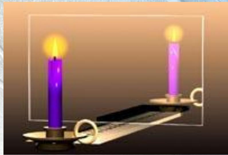
Чтобы убедиться в правильности второго вывода, измерим по линейке расстояния от стекла до свечи и от стекла до изображения. Они окажутся равны. Подтвердить третий вывод тоже несложно: угольник с прямым углом нужно приложить к линейке.
