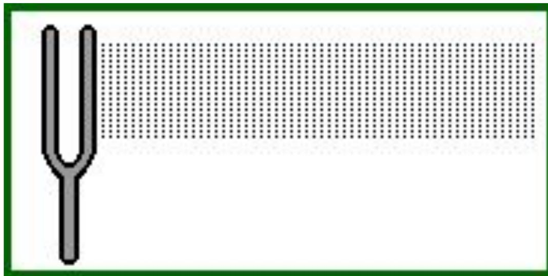
*Камертон* - представляет собой металлическую "рогатку", укрепленную на ящичке, у которого нет одной стенки. Если специальным резиновым молоточком ударить по "ножкам" камертона, то он будет издавать звук, называемый **музыкальным тоном**.
