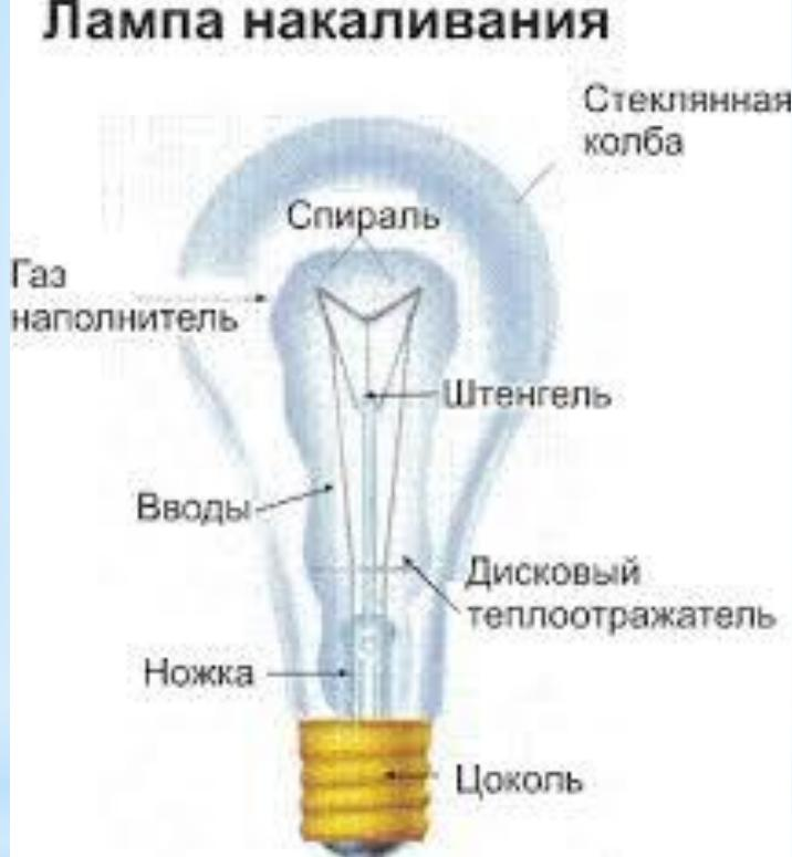
**Принцип действия:** свет в лампах накаливания создается путем прохождения электрического тока через тонкую проволоку, обычно изготовленную из вольфрама. Принцип действия основан на тепловом действии электрического тока.
