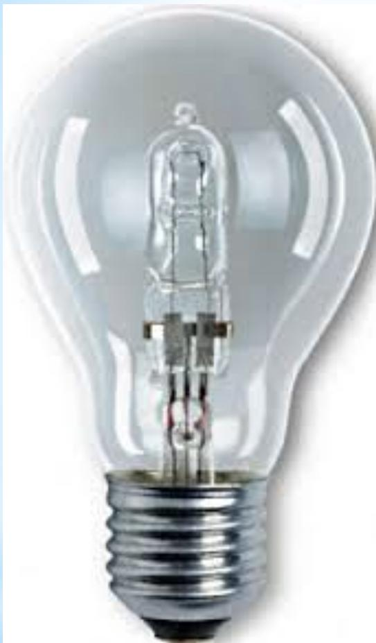
**Преимущества:** Спираль имеет более высокую температуру, что позволяет получить больше света при той же мощности лампы, спираль постоянно обновляется, что увеличивает срок службы лампы, колба не чернеет, и лампа дает постоянный световой поток в течение всего срока эксплуатации. При одинаковой способности к цветопередаче с лампами накаливания, имеют компактную конструкцию.
