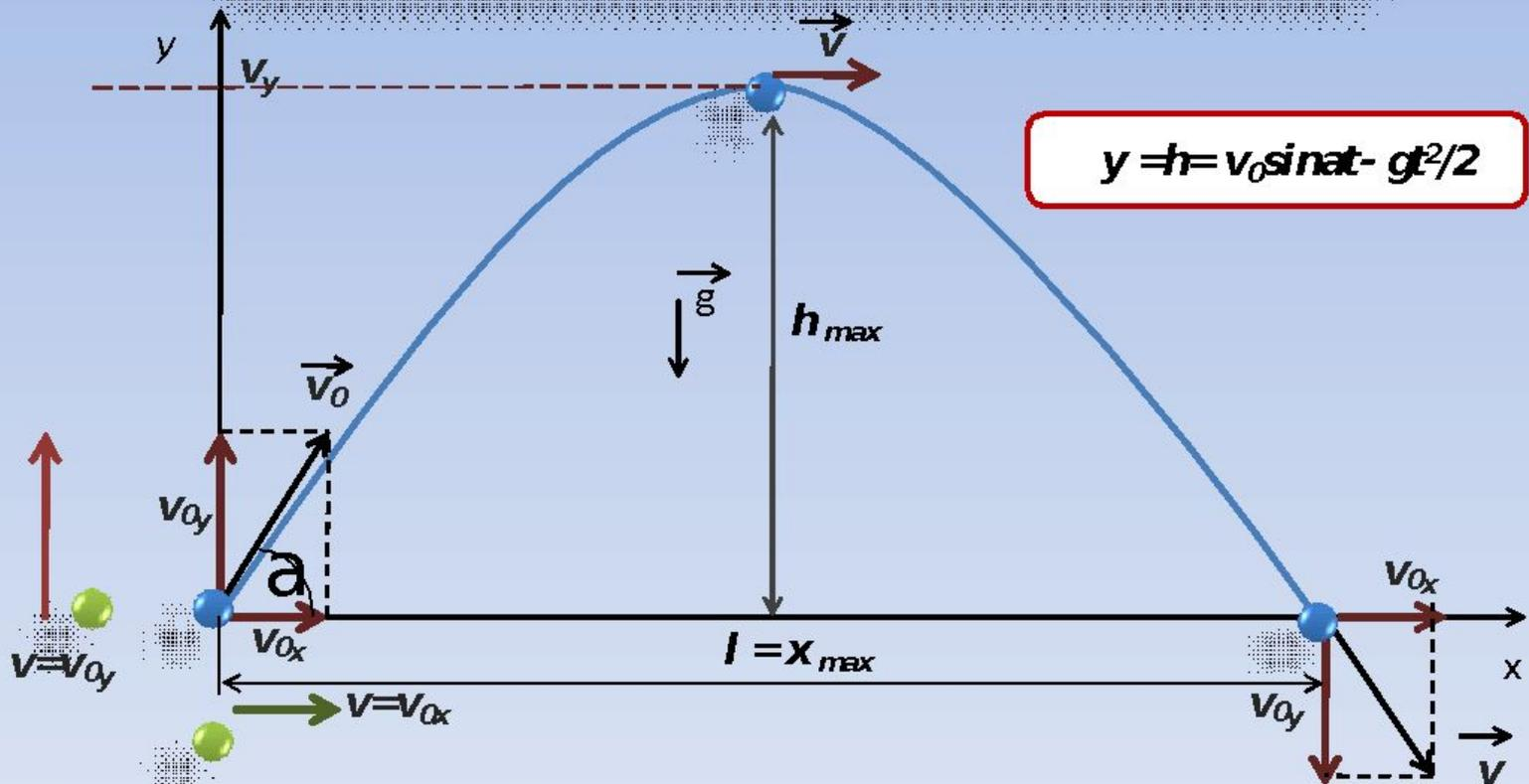
Дальность полёта при одной и той же начальной скорости зависит от угла
