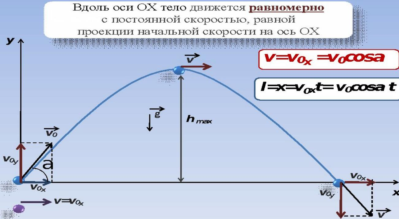
Т.о. при рассмотрении движения вдоль оси  $OX$  нужно пользоваться формулами, полученными для равномерного движения
