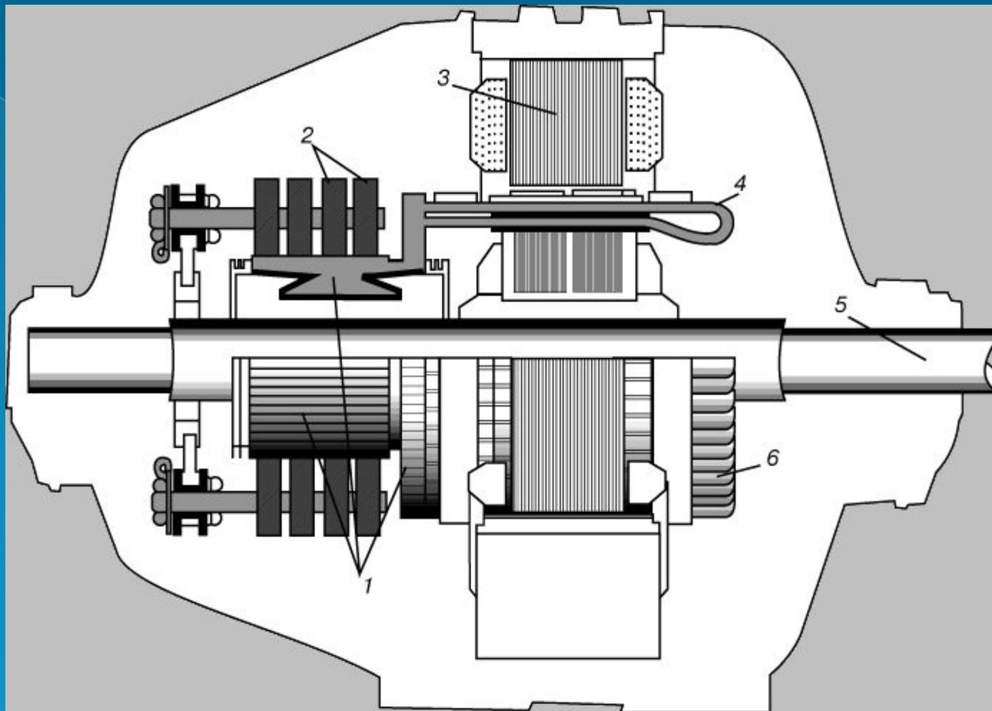
1 – коллектор; 2 – щетки; 3 – магнитные полюса; 4 – витки; 5 – вал; 6 – якорь
