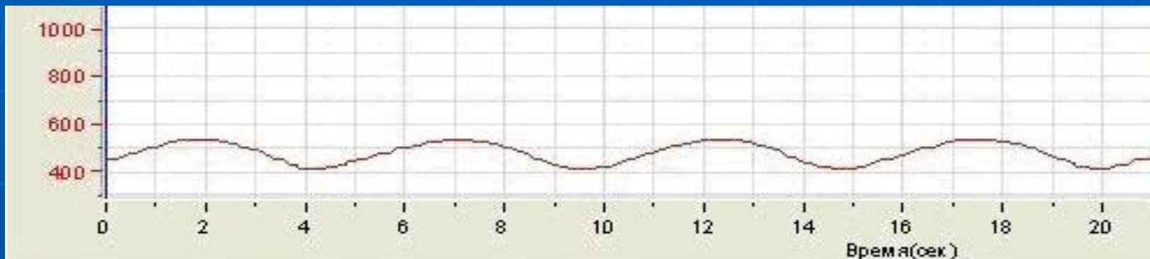
Нормой освещенности являются 500 люксов. При измерении и компактные люминесцентные лампы, и светодиоды показали норму.
