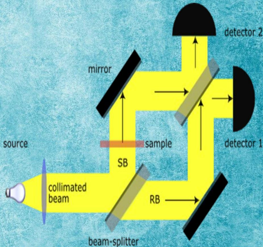
Схема интерферометра Маха —
