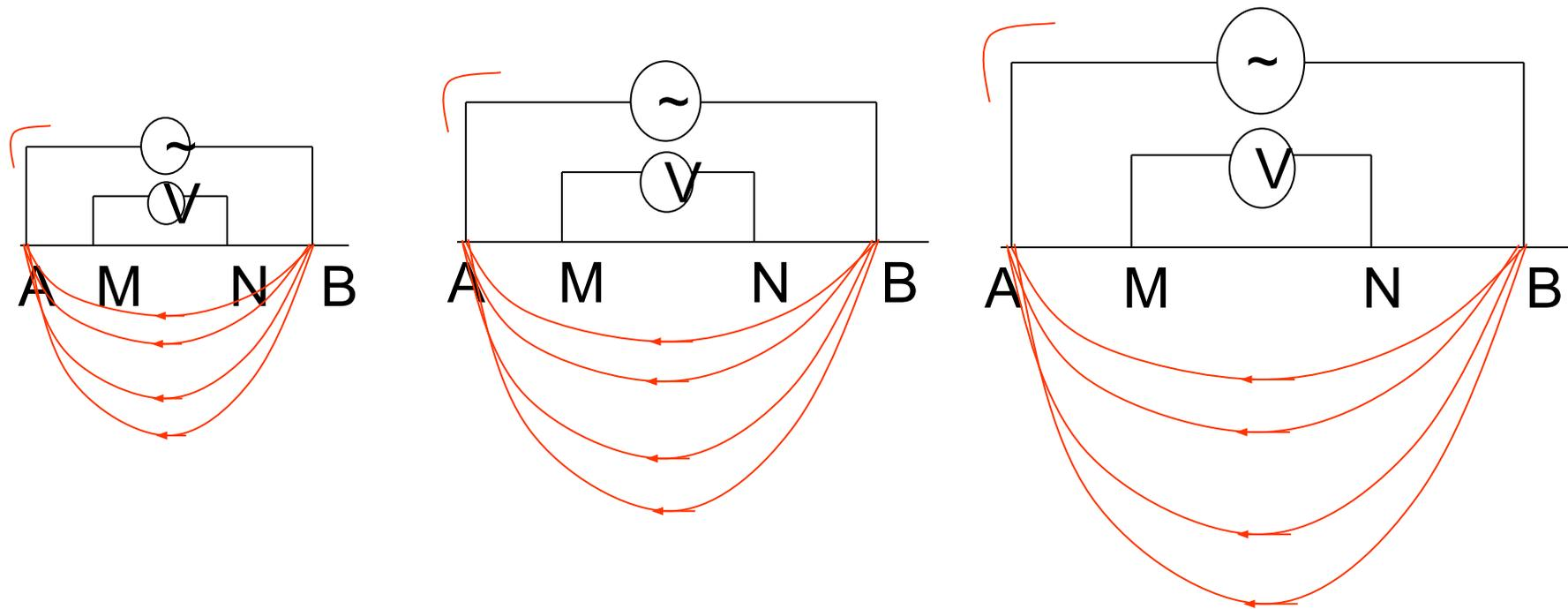
Расстояние между приемными и токовыми элементами установки позволяет изменять глубину исследования!
