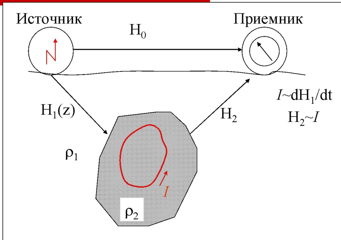
Электромагнитная индукция в Земле при наличии электропроводящего объекта ( $\rho_2 \ll \rho_1$ ).  $H_0$  - первичное магнитное поле источника,  $H_1$  - нормальное магнитное поле в Земле,  $H_2$  - вторичное магнитное поле, вызванное вихревыми электрическими
