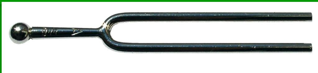
Камертон служит эталоном высоты звука при настройке музыкальных инструментов и в пении
