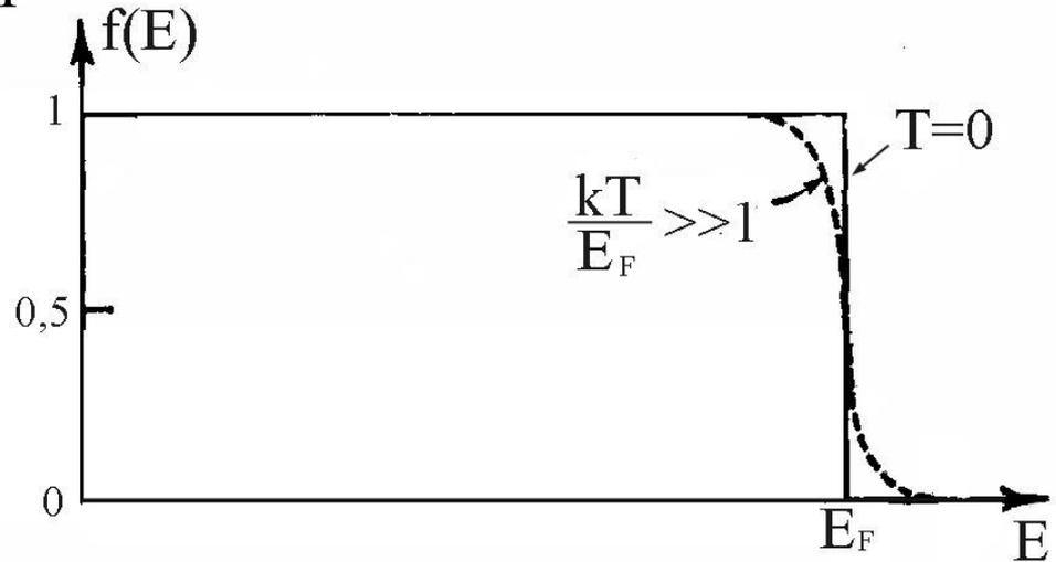
Энергия  $E_F$  называется **энергией Ферми**. При абсолютном нуле ( $T = 0^\circ\text{K}$ )  $f = 1$  при  $E < E_F$  и  $f = 0$  при  $E > E_F$ . Таким образом, при абсолютном нуле  $E_F$  имеет смысл предельной энергии; все состояния с энергией, меньшей  $E_F$ , заняты, а все состояния с энергией, большей  $E_F$ , вакантны.
