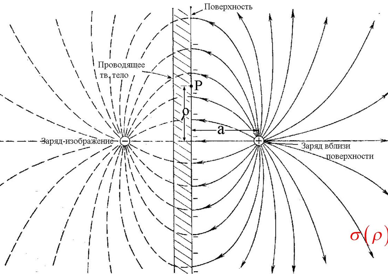
В точке Р на расстоянии **a** и **ρ** составляющая поля положительного точечного заряда, нормальная к поверхности, равна:
