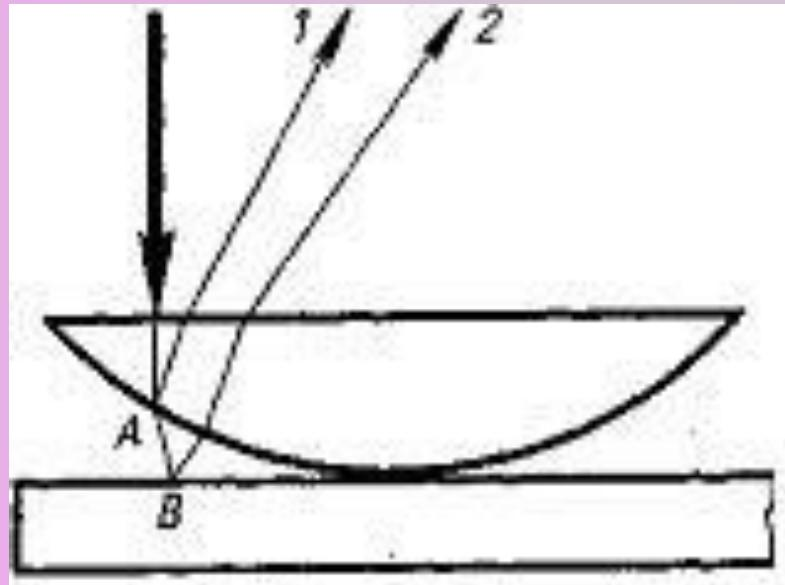
Интерференционная картина в тонкой прослойке воздуха между стеклянными пластиинами.
