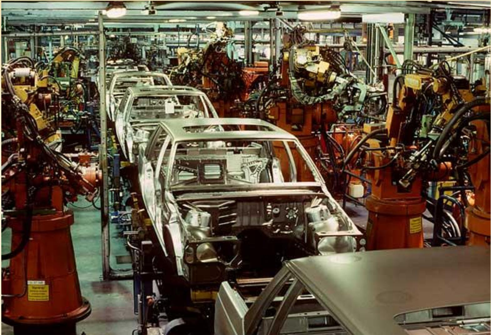
Роботизированная линия сборки, управляемая компьютером и запрограммированная на производство около 3000 сварных швов на корпусе каждого автомобиля, проходящего по конвейеру.
