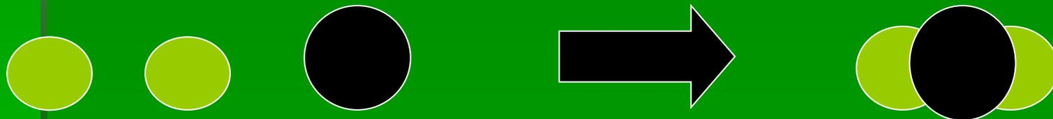
Топливо содержит углерод. При горении происходит химическая реакция окисления – атомы углерода соединяются с атомами кислорода, содержащимися в воздухе. В результате образуются молекулы углекислого газа. Кинетическая энергия этих молекул оказывается больше, чем у исходных частиц. Увеличение кинетической энергии молекул в процессе горения и называют выделением энергии. Энергия, выделяющаяся при полном сгорании топлива, называется теплотой сгорания топлива.
