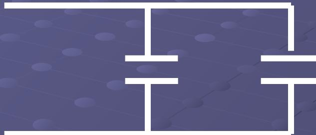
При параллельном включении
