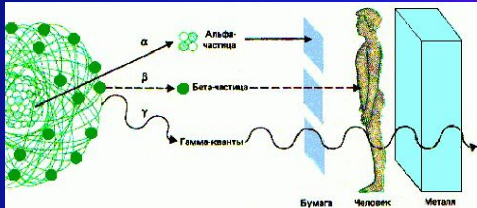
Гамма-излучение обладает большой проникающей способностью, т. е. может проникать сквозь большие толщи вещества без заметного ослабления.
