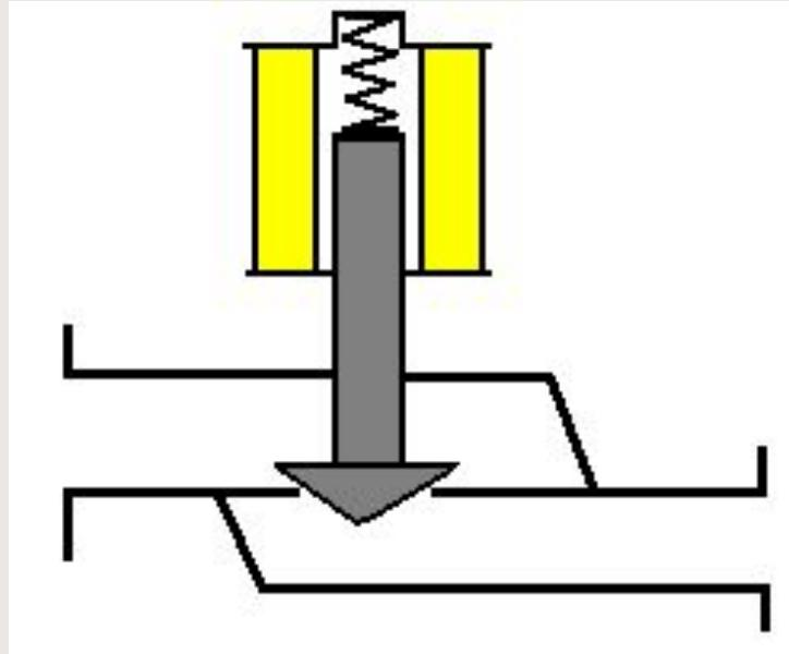
Пружина прижимает сердечник с клапаном к седлу.
