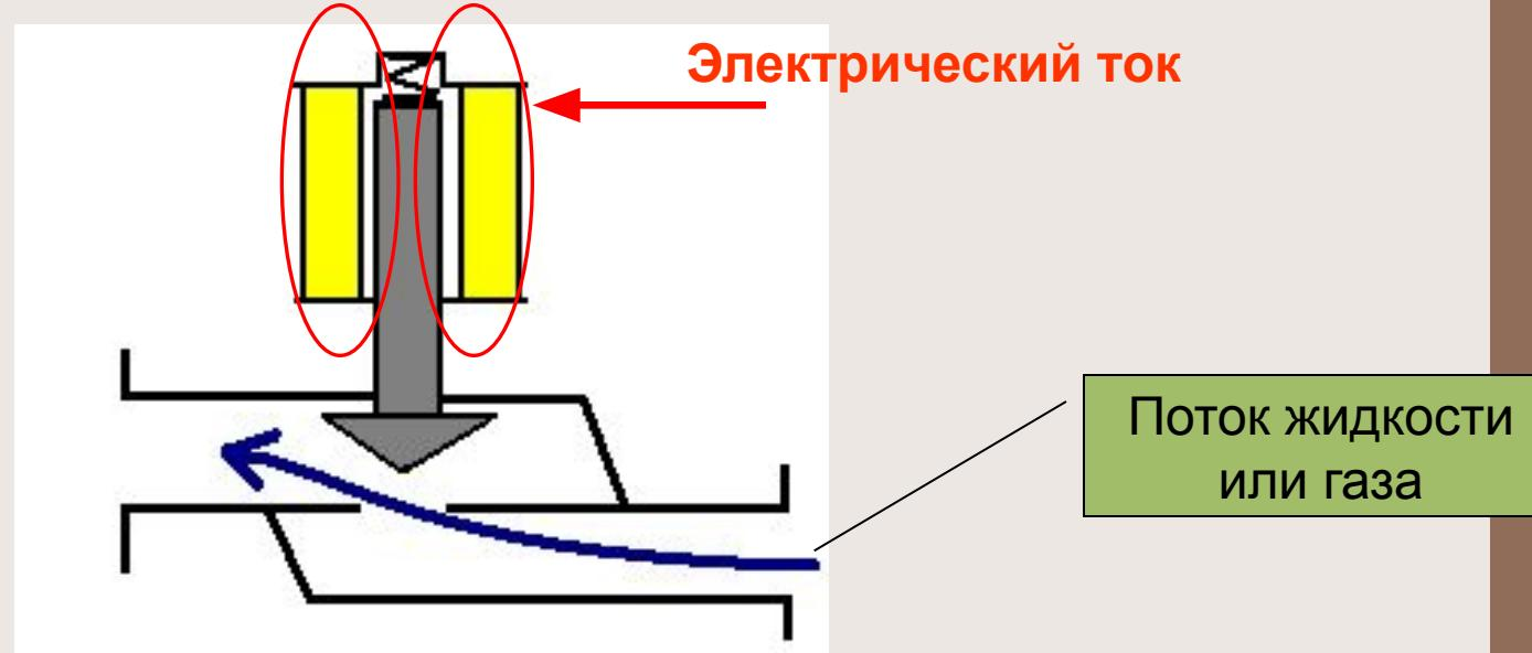
Открывается проход потоку жидкости или газа
