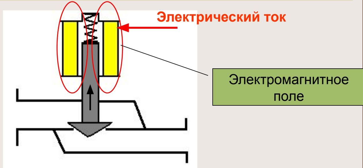
Когда на катушку подается электрический ток, в ней возникает электромагнитное поле, которое намагничивает сердечник и сердечник втягивается в катушку сжимая пружину.
