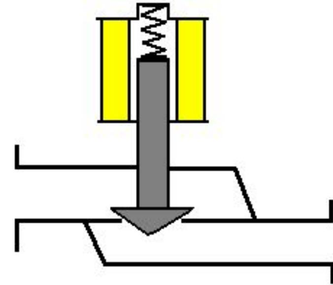
При обесточивании катушки электромагнитное поле исчезает и пружина опускает клапан на седло. Проход закрывается.
