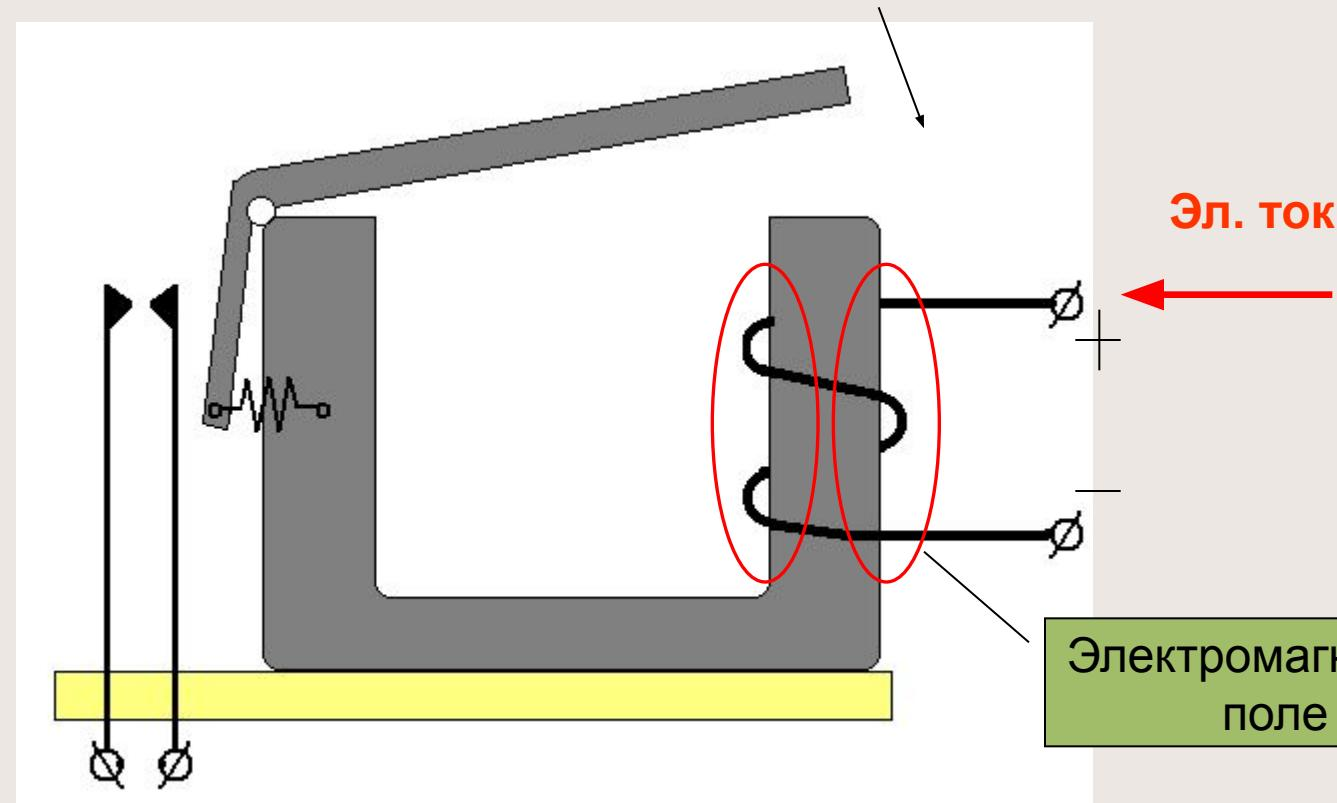
На катушку подается электрический ток. Электрический ток в катушке создает электромагнитное поле, которое намагничивает сердечник.
