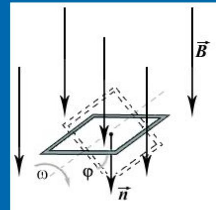
Это означает, что по замкнутой рамке будет течь электрический ток, меняющийся по синусоидальному закону, а на концах разомкнутой рамки напряжение будет меняться по закону
